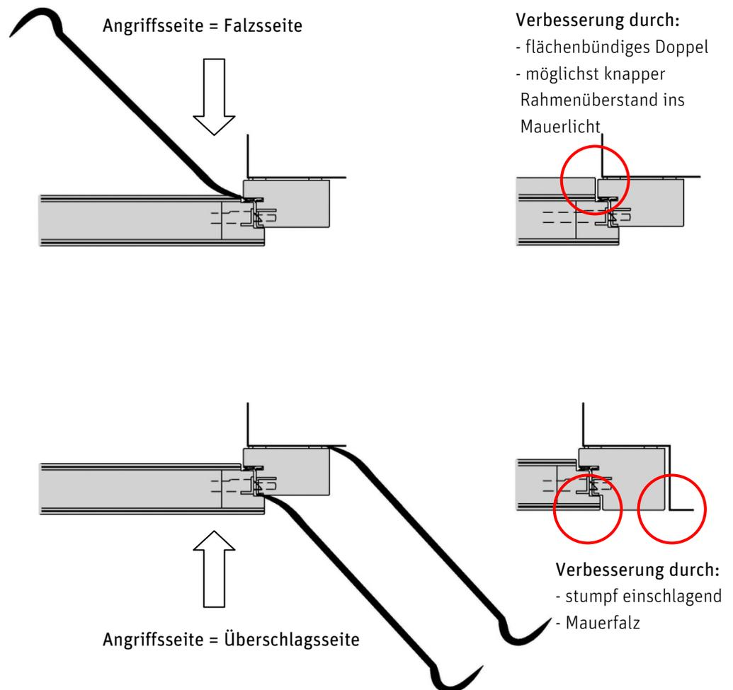
**Schwelldetail** Bei Aussentüren ist beim Einbruchschutz ein niedriges Schwelldetail genauso sinnvoll wie beim behindertengerechten Bauen. Wird allerdings eine Schlagregen-Dichtigkeit gefordert, könnte sich eine niedrige Schwelle nachteilig auswirken.
